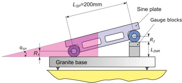
Figure 3. Tilt angle etalon.
